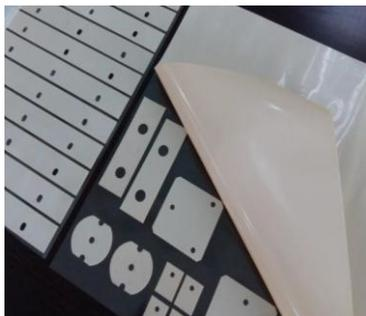
TIS<sup>®</sup>800K 系列是一款在聚酰亚胺薄膜上涂覆陶瓷混合导热材料的导热硅胶产品，具备优异的导热性与热传导效率。TIS<sup>®</sup>800K可通过螺丝安装于设备开孔处，复合聚酰亚胺薄膜提供优良的耐电压绝缘性能，表面的柔软导热涂层则有效提升空隙填充能力与操作便利性。
