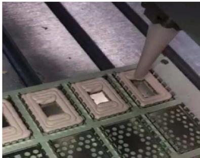
**TIF®050AB-11S** 是一款高导热液态间隙填充材料，采用双组分设计，具备依温度调整固化时间的特性。其柔韧且具弹性的材料特性，使其能紧密贴合不平整表面，将热量有效导出至金属外壳或散热板，提升电子元件的散热效率与使用寿命。液态形态可灵活提供不同厚度，取代传统导热垫片的模切限制。
