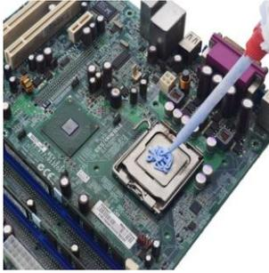
**TIF®030AB-05S** 是一种高导热液态间隙填充材料，具有双组份及不同温度固化时间特点。其柔性、弹性特征使其能够用于覆盖非常不平整的表面。热量从分离器件或整个PCB传导到金属外壳或扩散板上，能提高发热电子组件的效率和使用寿命。以液态方式，提供各种厚度，取代一般导热垫片的模切厚度，且不同于一般硅胶片，此系列产品固化后是干燥可触摸的，故可被更广泛应用。
